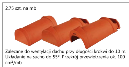
2,75 szt. na mb Zalecane do wentylacji dachu przy długości krokwi do 10 m. Układanie na sucho do 55°. Przekrój przewietrzenia ok. 100 cm 2 /mb Gąsior krańcowy nr 19 Gąsior początkowy nr 19 Gąsior nr 19
